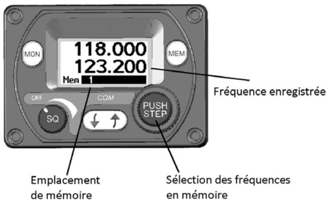
La rotation du petit bouton rotatif de sélection des fréquences permet de faire défiler les différents emplacements de mémoire. La fenêtre de fréquence standby affiche la fréquence enregistrée.
