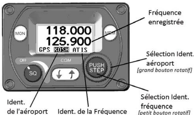
Le grand bouton rotatif de sélection des fréquences permet de parcourir les aéroports disponibles. Le petit bouton rotatif de sélection des fréquences permet de parcourir les fréquences individuelles associées à l'aéroport de votre choix. La mémoire intégrée du panneau de contrôle s'affiche lorsque vous avez fini de faire défiler tous les aéroports chargés ou s'il n'y a pas de GPS connecté.
