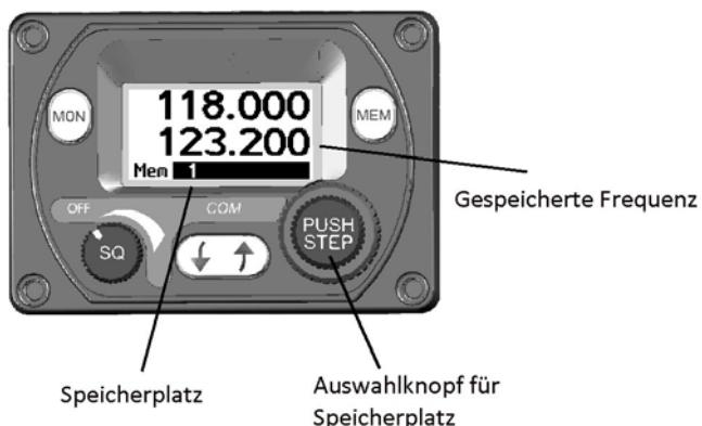
Durch Drehen des kleinen Frequenzwahlknopfes werden die Speicherplätze nacheinander aufgerufen. Die gespeicherte Frequenz wird in der Standby-Frequenzanzeige angezeigt.
