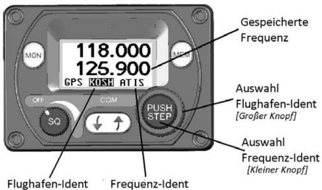
Mit Hilfe des großen Frequenzwahlknopfes kann die Liste der verfügbaren Flughäfen durchgeblättert werden. Mit Hilfe des kleineren Frequenzwahlknopfes kann die Liste der einzelnen mit diesem Flughafen verbundenen Frequenzen durchgeblättert werden. Nachdem Sie alle geladenen Flughäfen durchgegangen sind, oder falls kein GPS angeschlossen ist, wird der eingebaute Speicher des Bediengeräts angezeigt.
